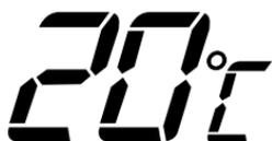
Die Temperaturanzeige zeigt die Umgebungslufttemperatur. Wenn die Umgebungslufttemperatur unter 3°C liegt, blinkt die Temperaturanzeige im Display ⑧ und leuchtet nach 30 Sekunden dauerhaft. Drücken Sie die Taste ADJ ⑮, um zur ursprünglichen Anzeige zurückzukehren. Wenn die Umgebungslufttemperatur über 5°C liegt, kehrt das Display automatisch zur ursprünglichen Anzeige zurück.
