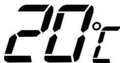
Die Temperaturanzeige zeigt die Umgebungslufttemperatur. Wenn die Umgebungslufttemperatur unter 3 °C (38 °F) liegt, blinkt die Temperaturanzeige im Display ⑧ und leuchtet nach 30 Sekunden dauerhaft. Drücken Sie die Taste ADJ ⑮, um zur ursprünglichen Anzeige zurückzukehren. Wenn die Umgebungslufttemperatur über 5 °C (41 °F) liegt, kehrt das Display automatisch zur ursprünglichen Anzeige zurück.
