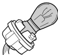
3. Drücken Sie die durchgebrannte Lampe hinein, drehen Sie sie nach links, und ziehen Sie sie heraus.
