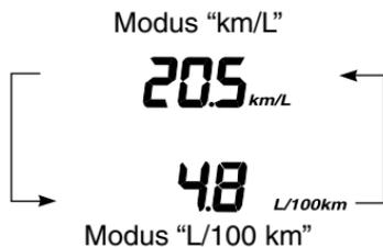
Zum Umschalten zwischen den Modi "km/L" und "L/100 km" stellen Sie die Anzeige ⑰ entweder auf Anzeige für momentanen Kraftstoffverbrauch oder auf Anzeige für durchschnittlichen Kraftstoffverbrauch und halten Sie den Schalter MODE (Abwärts) dann 2 Sekunden lang gedrückt.
