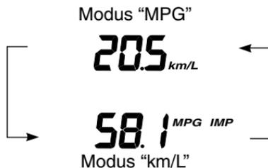
Zum Umschalten zwischen den Modi "km/L (L/100 km)" und "MPG" stellen Sie die Anzeige ⑳ auf Gesamtkilometerzähler, und halten Sie dann die Taste ADJ ① 2 Sekunden lang gedrückt. Gleichzeitig wird der Gesamtkilometerzähler zwischen Kilometer und Meilen umgeschaltet.
