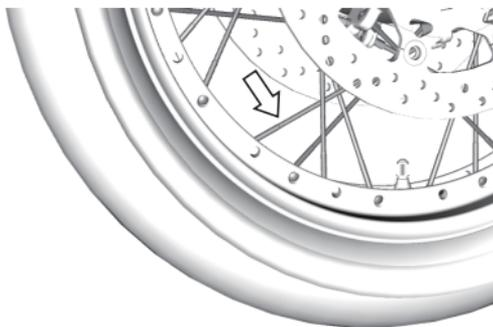
Lockere Speichennippel sind gleichmäßig mit dem vorgeschriebenen Anzugsdrehmoment anzuziehen. Lockere und überzogene Speichennippel können ungleichmäßige Spannung der Speichen verursachen und zu einer Verformung der Radfelge führen. Lassen Sie diese Wartungsarbeit von Ihrem Suzuki-Händler vornehmen.
