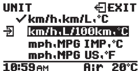
3. Drücken Sie den Wahlschalter (abwärts) etwa 2 Sekunden lang. Das Häkchen „✓“ bewegt sich zu den gewählten Einheiten. Gleichzeitig schaltet das Instrument auf die gewählten Einheiten.
