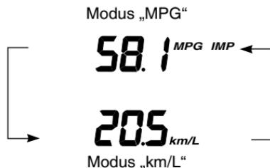
Zum Umschalten zwischen den Modi „MPG“ und „km/L (L/100 km)“ stellen Sie die Anzeige auf Gesamtkilometerzähler, und halten Sie dann 2 Sekunden lang die Taste ADJUST ① gedrückt.
