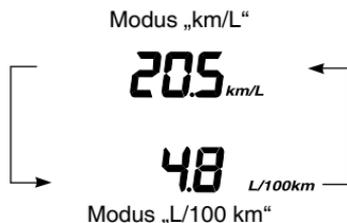
Zum Umschalten zwischen den Modi „km/L“ und „L/100 km“ stellen Sie die Anzeige entweder auf Anzeige für momentanen Kraftstoffverbrauch oder auf Anzeige für durchschnittlichen Kraftstoffverbrauch und halten Sie den Schalter MODE (Abwärts) dann 2 Sekunden lang gedrückt.
