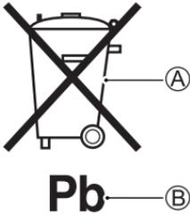
Das Symbol **Ⓐ** (durchgestrichene Mülltonne) auf dem Batterieticket weist darauf hin, dass die Batterie bei Anfall getrennt von normalem Haushaltsabfall entsorgt werden muss.
