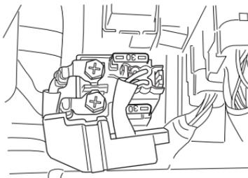
Die Hauptsicherung befindet sich unter dem Sitz. Im Sicherungskasten befindet sich eine 30-A-Reservesicherung.
