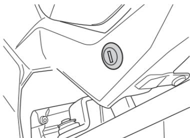
Zum Abnehmen des Sitzes stecken Sie den Zündschlüssel in das Schloss ein und drehen Sie ihn im Uhrzeigersinn. Heben Sie den Sitz hinten an und ziehen Sie ihn zurück.
