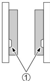
Prüfen Sie, ob die Vorder- und Hinterradbremsebeläge bis zur Verschleißlinie ① abgenutzt sind. Wenn ein Bremsbelag, vorn oder hinten, bis zur genutzten Verschleißlinie abgenutzt ist, müssen beide Bremsbeläge des entsprechenden Rads von Ihrem Suzuki-Vertragshändler oder qualifiziertem Fachpersonal ausgewechselt werden.
