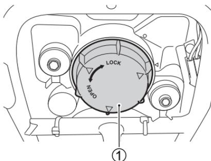
1. Drehen Sie den Deckel ① entgegen dem Uhrzeigersinn und nehmen Sie ihn ab.
