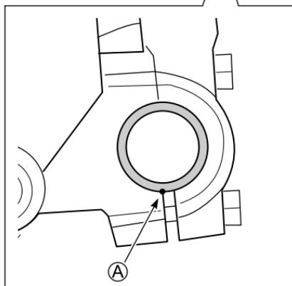
Richten Sie die Punktmarkierung an der Lenkstange auf die Passfläche des Hebelhalters **A** aus.
