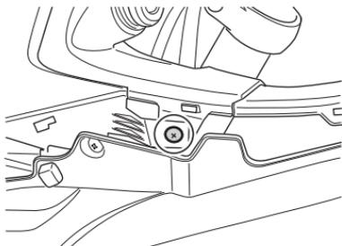
2. Entfernen Sie die Schrauben und die Befestigungsteile.
