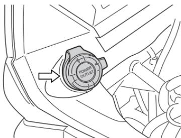
Das Modell DL650A/XA ist mit einer Bordsteckdose zum Anschluss von elektrischem 12-V-Zubehör ausgestattet. Die Gesamtwattzahl des elektrischen Zubehörs muss kleiner als 36 W sein. Bevor Sie elektrisches Zubehör an die Bordsteckdose anschließen, prüfen Sie dessen Ladespannung und Wattzahl.
