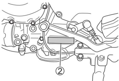
Die Seriennummer des Rahmens und/oder des Motors werden für die Anmeldung des Motorrads benötigt. Außerdem erleichtern sie Ihrem Händler die Bestellung von Teilen und das Auffinden spezieller Wartungsinformationen. Die Rahmennummer ① ist am Lenkkopfrohr eingestanz. Die Motornummer ② ist am Kurbelgehäuse eingestanz.
