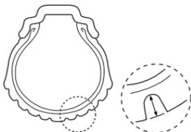
Kontrollieren Sie den Zustand der Reifen vor jeder Fahrt. Wenn ein Reifen sichtbare Anzeichen einer Beschädigung aufweist, wie z. B. Risse oder Einschnitte, bzw. wenn die Profiltiefe beim Vorderreifen 1,6 mm (0,06 in) und beim Hinterreifen 2,0 mm (0,08 in) unterschreitet, ist der Reifen auszuwechseln.
