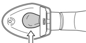
2. Drücken Sie die Glühlampe hinein, drehen Sie sie nach links, und ziehen Sie sie heraus.
