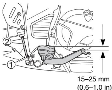
1. Lösen Sie die Sicherungsmutter ① und drehen Sie die Druckstange ②, um das Pedal auf 15–25 mm (0,6–1,0 in) unter der Oberseite der Fußraste zu positionieren.
