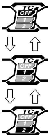
3. Drücken Sie den Traktionskontrollsystemschalter ⑥, um die Moduswahl abubrechen. Das Traktionskontrollsystem-Display in der Instrumentengruppe schaltet auf normalen Anzeigemodus zurück.
