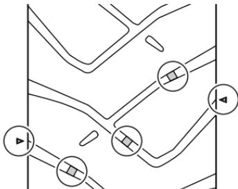
**ZUR BEACHTUNG:** Die Markierung „Δ“ zeigt die Stelle an, wo die im Reifen eingelassenen Verschleißindikatoren sind. Wenn der Verschleißindikator dieselbe Höhe besitzt wie die Reifenoberfläche, ist die Verschleißgrenze des Reifens erreicht.
