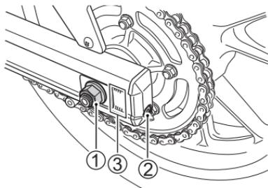
2. Lösen Sie die Achsmutter ①.
