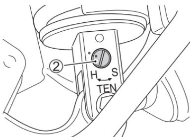
Der Ausfederdämpfungskraft-Einsteller ② befindet sich am unteren Teil der Hinterradaufhängungsdämpfereinheit. Zum Einstellen der Dämpfungskraft bringen Sie den Einsteller zunächst in die Standardposition und dann in die gewünschte Position. Zum Einstellen des Dämpfungskraft-Einstellers auf die Standard-Position:
