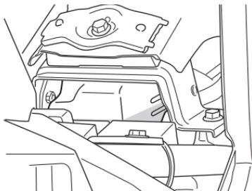
Nehmen Sie den Sitz ab, um den Kühlmittelstand zu kontrollieren. Der Kühlmittelstand im Ausgleichbehälter soll sich stets zwischen den Pegellinien „F“ (voll) und „L“ (niedrig) befinden. Kontrollieren Sie den Füllstand bei senkrecht stehendem Motorrad vor jeder Fahrt. Wenn der Kühlmittelstand die Pegellinie „L“ unterschreitet, füllen Sie vorgeschriebenes Motor­kühlmittel wie folgt nach:
