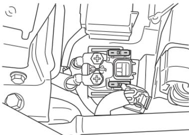
3. Entnehmen Sie die Sicherung und überprüfen Sie sie.
