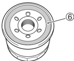
7. Verteilen Sie ein wenig Motoröl um die Gummidichtung ⑥ des neuen Ölfilters.
