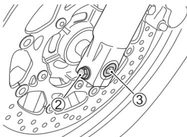
4. Lösen Sie die Achshalterschraube ② an der linken Teleskopgabel.
