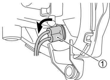
1. Drehen Sie die Fassung ① entgegen dem Uhrzeigersinn und nehmen Sie sie ab.
