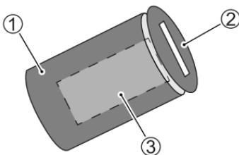
Ein Deckel ② ist für den Schlüsselzylinder ① vorgesehen, um unbefugte Eingriffe zu verhindern. Durch Drehen des Deckels kann die Schlüsselöffnung ③ abgedeckt werden, sodass keine Fremdkörper in die Schlüsselöffnung gelangen können. Zum Drehen des Deckels führen Sie die Spitze des Schlüssels leicht in diesen ein und drehen Sie ihn.
