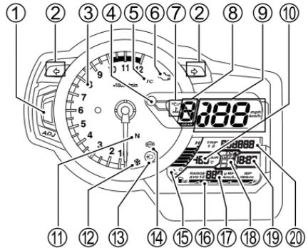
Die Störungsanzeigeleuchte ⑥, die Frost-Anzeigeleuchte ⑫, die Kühlmitteltemperaturanzeige/Öldruck-Anzeigeleuchte ④, die ABS-Anzeigeleuchte ⑭, die Traktionskontrollsystem-Anzeigeleuchte ⑤, die LCDs und die Drehzahlmessernadel zeigen ihre Betriebsbereitschaft bei Drehen des Zündschalters auf „ON“ wie folgt an.
