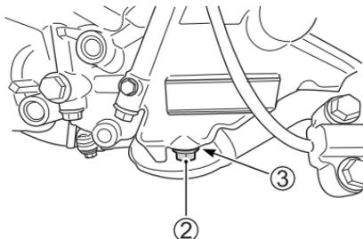
4. Nehmen Sie die Ablassschraube ② sowie die Dichtung ③ von der Unterseite des Motors ab, und lassen Sie das Motoröl in eine geeignete Wanne ablaufen.
