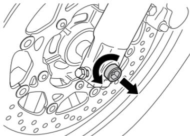
8. Drehen Sie die Achse ③ entgegen dem Uhrzeigersinn und ziehen Sie sie heraus.
