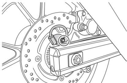
2. Nehmen Sie den Hinterraddrehzahlsensor nach Herausdrehen der Befestigungsschraube ab.
