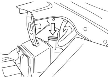
2. Nehmen Sie die Einfüllkappe ab und füllen Sie vorgeschriebenes Kühlmittel über die Einfüllöffnung nach, bis es die Linie „F“ erreicht. Siehe Abschnitt EMPFEHLUNGEN ZU KRAFTSTOFF, MOTORÖL UND KÜHLMITTEL.
