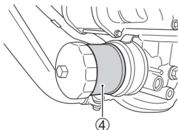
5. Drehen Sie den Ölfilter ④ mit einem Suzuki-Aufsetz-Ölfilterschlüssel oder einem Band-Filter-schlüssel geeigneter Größe entgegen dem Uhrzeigersinn.
