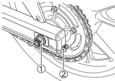
3. Schrauben Sie die Achsmutter ① ab.
