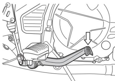
Durch Drücken des Hinterradbremspedals wird die Hinterrad-Scheibenbremse betätigt. Bei Betätigung der Hinterradbremse leuchtet die Bremsleuchte.
