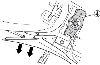
14. Nehmen Sie die Haken ab und drehen Sie die Schraube heraus. Nehmen Sie die Stütze ④ und den Gummidämpfer ab.
