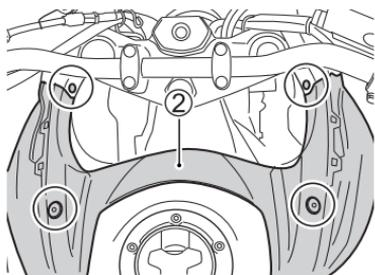
7. Nehmen Sie die Befestigungselemente und Schrauben ab. Nehmen Sie die vordere Kraftstofftankabdeckung (2) ab.
