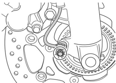
2. Nehmen Sie den Vorderraddrehzahlsensor nach Herausdrehen der Befestigungsschraube ab.
