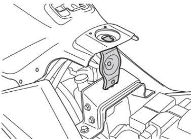
16. Stützen Sie den Kraftstofftank mit der Stütze ④ ab.
