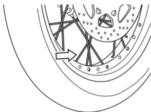
Prüfen Sie die Spannung der Speichen, um sicherzustellen, dass die Speichennippel fest sitzen. Die Speichenspannung kann dadurch geprüft werden, dass man mit einer kleinen Metallstange gegen die Speichen klopft. Wenn der entsprechende Speichennippel locker ist, hört man einen dumpfen Klang.
