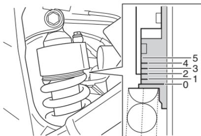
Die Vorspannung der Hinterradfederung kann durch Drehen des Einstellers ① eingestellt werden. Durch Drehen des Einstellers im Uhrzeigersinn wird die Federvorspannung erhöht, durch Drehen entgegen dem Uhrzeigersinn wird sie vermindert. Position 0 ergibt die weichste, Position 5 die härteste Federvorspannung. Die Einstellschraube ist ab Werk und bei Auslieferung des Motorrads auf Position 2 eingestellt.
