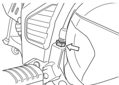
Um den Bremslichtschalter einzustellen, heben Sie diesen Schalter an oder senken Sie ihn ab, sodass das Bremslicht bei Betätigung des Bremspedals kurz vor dem Druckpunkt aufleuchtet.
