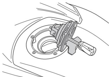
Zum Öffnen des Tankdeckels stecken Sie den Zündschlüssel in das Schloss und drehen Sie ihn im Uhrzeigersinn. Öffnen Sie den Tankdeckel mit dem Schlüssel. Zum Schließen drücken Sie den Tankdeckel mit dem im Deckelschloss steckenden Schlüssel fest nach unten.
