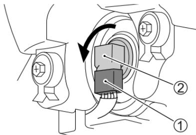
1. Ziehen Sie den Stecker ab ①. Drehen Sie die Fassung ② entgegen dem Uhrzeigersinn und nehmen Sie sie ab.
