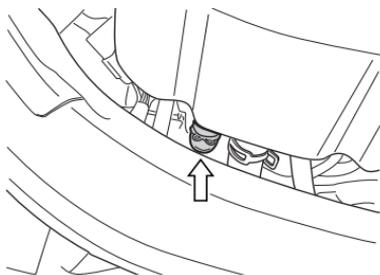
2. Bei der turnusgemäßen Wartung drehen Sie die Schraube heraus und lassen Wasser sowie Öl ab. Die Luftfiltereinsatz-Ablassschraube befindet sich unter dem Luftfiltergehäuse.
