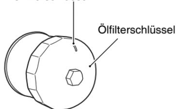
In der Position, bei der die Filterdichtung zuerst die Sitzfläche berührt.
