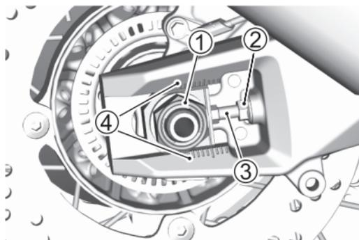
3. Lösen Sie die Sicherungsmuttern ②, rechts und links.
