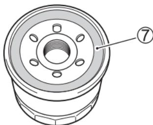
8. Drehen Sie den neuen Filter von Hand ein, bis die Filterdichtung die Sitzfläche berührt (ein leichter Widerstand ist zu spüren).
