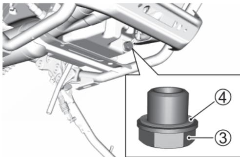
12. Füllen Sie 3500 ml (3,7/3,1 US/Imp qt) frisches Motoröl über die Einfüllöffnung nach und schrauben Sie die Motoröl-Einfüllkappe wieder auf. Verwenden Sie unbedingt das vorgeschriebene Motoröl, wie im Abschnitt „MOTORÖL AUSWÄHLEN“ auf Seite 3-28. beschrieben.
