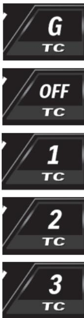
*ZUR BEACHTUNG: Überprüfen Sie vor der Fahrt den Einstellmodus in der Anzeige des Traktionskontrollsystems auf der Instrumententafel.*
