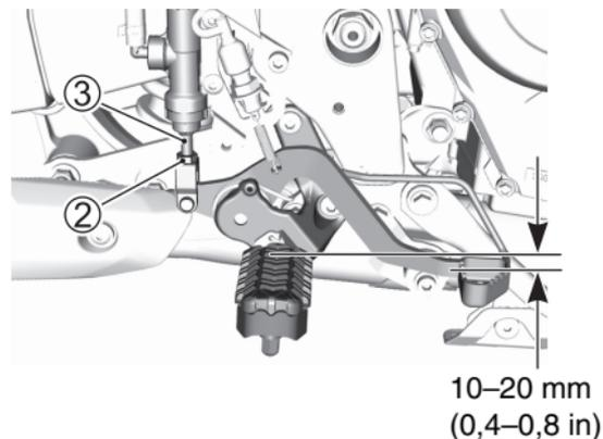
3. Ziehen Sie die Sicherungsmutter ② wieder an, um die Druckstange ③ in der richtigen Position festzustellen.
