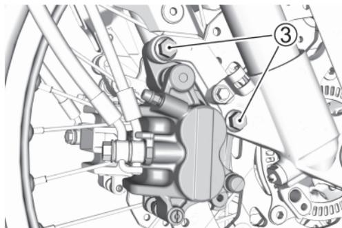
**ZUR BEACHTUNG:** Ziehen Sie bei ausgebautem Bremssattel niemals den Bremshebel. Die Bremsbeläge lassen sich nur sehr schwer in den Bremssattel zurückdrücken und Bremsflüssigkeit kann auslaufen.
