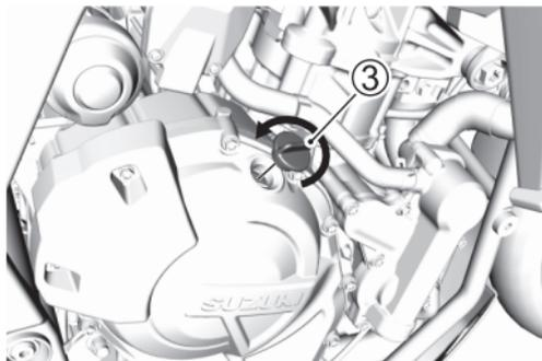
3. Halten Sie das Motorrad senkrecht und füllen Sie Öl nach, bis die Oberfläche des Motoröls zwischen den Markierungen F (oberer Pegel) ① und L (unterer Pegel) ② liegt.
