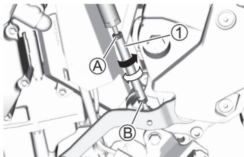
2. Drehen Sie die Stange **1** nach rechts ( $\Rightarrow$ ), um die Pedalposition anzuheben, und in die entgegengesetzte Richtung ( $\Leftarrow$ ), um sie abzusenken.
