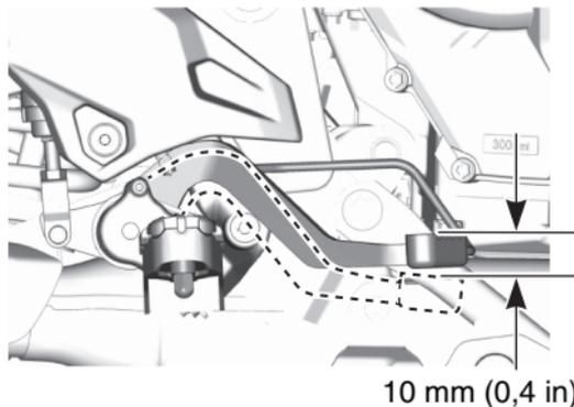
Halten Sie das Gehäuse des Hinterradbremlichtschalters ① mit Ihren Fingern fest, sodass es sich nicht drehen kann, und drehen Sie dann zum Einstellen an dem Einsteller ②. Wird die Mutter, wie dargestellt, in Richtung A gedreht, leuchtet die Bremsleuchte früher auf. Wird sie, wie dargestellt, in Richtung B gedreht, leuchtet die Bremsleuchte später auf.
