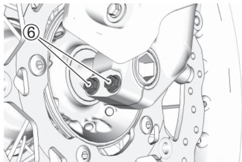
17. Bringen Sie die Bremssättel und den Drehzahlsensor wieder an.
