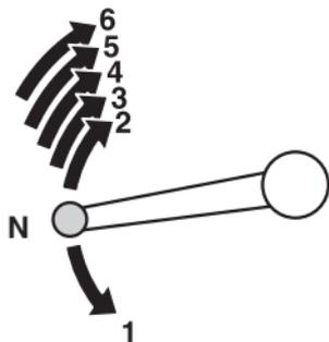
*ZUR BEACHTUNG: Wenn sich das Getriebe im Leerlauf befindet, leuchtet die grüne Anzeigeleuchte in der Instrumententafel. Dennoch sollten Sie auch bei leuchtender Anzeige den Kupplungshebel vorsichtig und langsam loslassen, um sicherzugehen, dass sich das Getriebe wirklich im Leerlauf befindet.*
