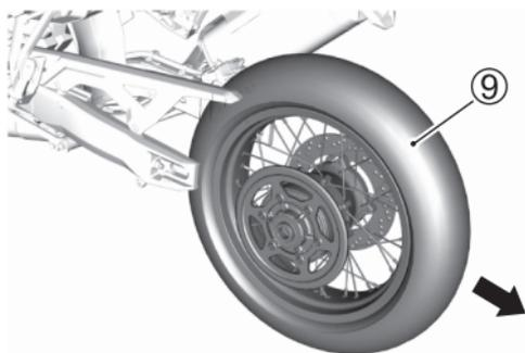
*ZUR BEACHTUNG: Drücken Sie bei ausgebautem Hinterrad niemals auf das Hinterradbremspedal. Die Bremsbeläge können sonst nicht ohne Weiteres in die Bremssattelbaugruppe zurückgedrückt werden.*
