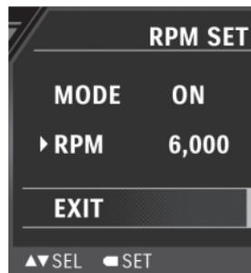
4. Wählen Sie mit den WAHLSCHALTERN ▲ / ▼ den Menüpunkt „EXIT“ (Zurück) und bestätigen Sie mit dem Schalter MODE, um zur Anzeige MENU (Menü) zurückzukehren.
