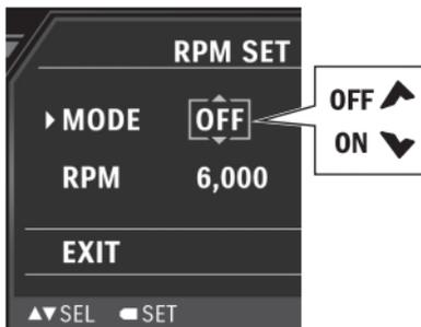
3. Drücken Sie den Schalter MODE, um die Einstellung zu bestätigen. Wenn „ON“ (Ein) eingestellt ist, wird die Motordrehzahlanzeige ③ eingeblendet.
