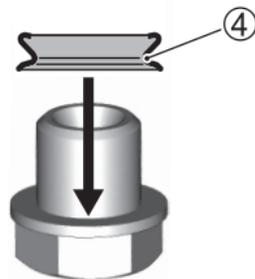
11. Bringen Sie die Ablassschraube ③ mit der Dichtung ④ wieder an. Ziehen Sie die Schraube mit einem Drehmoment-schlüssel fest.
