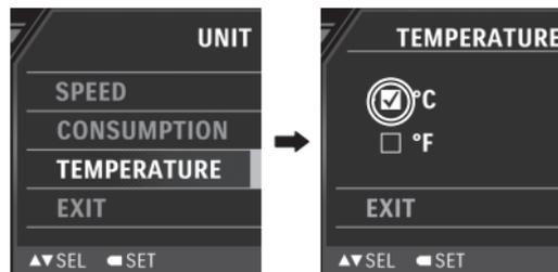
5. Setzen Sie mit den WAHLSCHALTERN ▲ / ▼ die Auswahl ▶ auf die anzuzeigende Maßeinheit.
