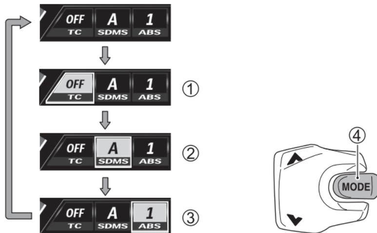
Zum Ändern der Anzeige drücken Sie den Schalter MODE ④.
