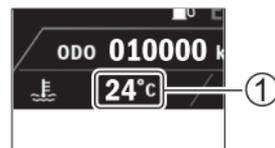
Es ist keine Fehlfunktion, wenn die Temperaturanzeige große Sprünge macht. Da die Möglichkeit einer Überhitzung besteht, wenn das Display über 120 °C (248 °F) heiß wird, siehe „BEI ÜBERHITZUNG (MOTORKÜHLMITTELTEMPERATUR-WARNANZEIGELEUCHE LEUCHTET AUF)“ auf Seite 4-4.
