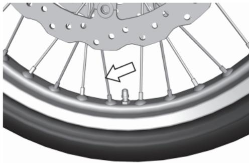
Lockere Speichennippel sind gleichmäßig mit dem vorgeschriebenen Anzugsdrehmoment anzuziehen. Lockere und überzogene Speichennippel können ungleichmäßige Spannung der Speichen verursachen und zu einer Verformung der Radfelge führen. Lassen Sie diese Wartungsarbeit von Ihrem Suzuki-Händler vornehmen.
