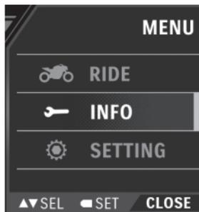
3. Wählen Sie mit den WAHLSCHALTERN ▲ / ▼ den Menüpunkt „NEXT SERVICE“ (Nächste Wartung) und bestätigen Sie mit dem Schalter MODE.
