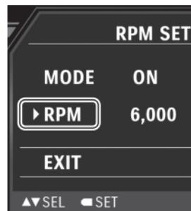
2. Wählen Sie mit den WAHLSCHALTERN ▲ / ▼ den gewünschten Drehzahlwert und bestätigen Sie die Einstellung mit dem Schalter MODE.
