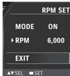
5. Wählen Sie mit den WAHLSCHALTERN ▲ / ▼ den Menüpunkt „EXIT“ (Zurück) und bestätigen Sie mit dem Schalter MODE, um zur Anzeige MENU (Menü) zurückzukehren.
