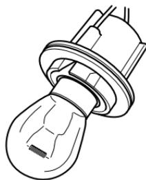
3. Drücken Sie die Lampe hinein und drehen Sie sie im Gegenuhrzeigersinn.
