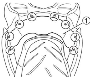
1. Nehmen Sie die Befestigungsteile ab. Nehmen Sie die Unterabdeckung ① ab.
