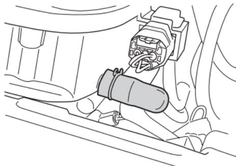
Bei Ablauf des regelmäßigen Wartungsintervalls drehen Sie die Schraube heraus, und lassen Sie Wasser sowie Öl ab. Die Luftfilter-Ablassschraube befindet sich unter dem Luftfiltergehäuse.
