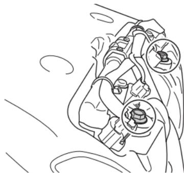
5. Drehen Sie die oberen Kraftstoffeinspritzventilschrauben heraus.
