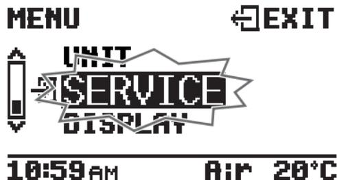
Bei Service-Erinnerung handelt es sich um eine Funktion, die mittels Anzeige und Anzeigeleuchte auf Grundlage der Einstellung des Datums und der Wegstrecke das Serviceintervall angibt.
