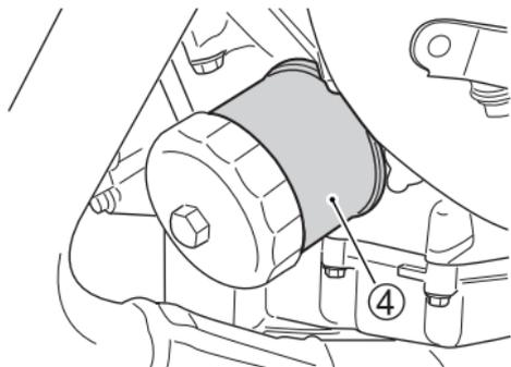
5. Drehen Sie den Ölfilter ④ im Gegenzeigersinn und nehmen Sie ihn ab. Verwenden Sie hierzu einen Suzuki-Aufsetz-Ölfilterschlüssel oder einen Band-Filterschlüssel geeigneter Größe.
