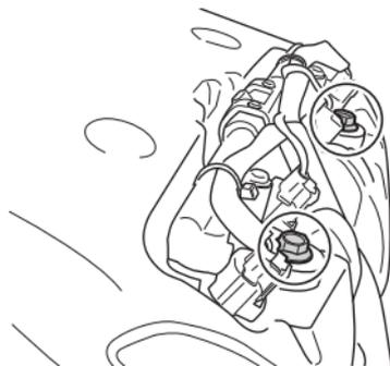
5. Drehen Sie die oberen Kraftstoffeinspritzventilschrauben heraus.
