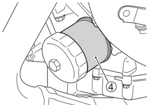
5. Drehen Sie den Ölfilter ④ entgegen dem Uhrzeigersinn und nehmen Sie ihn ab. Verwenden Sie hierzu einen Suzuki-Aufsetz-Ölfilterschlüssel oder einen Band-Filterschlüssel geeigneter Größe.
