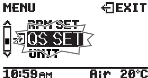
Schaltautomat einstellen. Bei aktiviertem Schaltautomaten ist das Hoch- und Herunterschalten ohne Kupplung ziehen oder Gas geben möglich.
