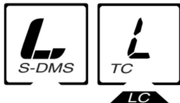
2. Wenn Sie die (START)-Seite des Motorstopp-/Elektrostarterschalters/Launch Control System-Schalters etwa 1 Sekunde lang bei gestopptem Motorrad drücken, wird das Launch Control System aktiviert, und die Launch Control System-Anzeige erscheint auf dem Instrument.
