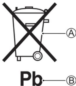
Das Symbol **A** (durchgestrichene Mülltonne) auf dem Batterieaufkleber weist darauf hin, dass die Altbatterie getrennt vom normalen Hausmüll entsorgt werden muss. Das chemische Symbol „Pb“ **B** bedeutet, dass die Batterie mehr als 0,004 % Blei enthält.
