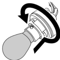
3. Drücken Sie die Glühlampe hinein, drehen Sie sie nach links, und ziehen Sie sie heraus.
