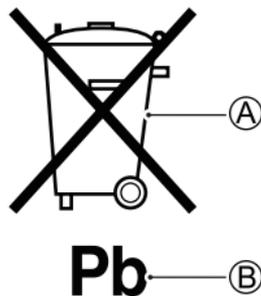
Das Symbol **Ⓐ** (durchgestrichene Mülltonne) auf dem Batterieaufkleber weist darauf hin, dass die Altbatterie getrennt vom normalen Hausmüll entsorgt werden muss. Das chemische Symbol „Pb“ **Ⓑ** bedeutet, dass die Batterie mehr als 0,004 % Blei enthält.
