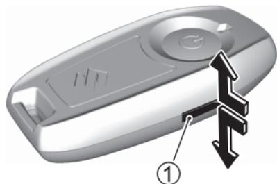
1. Zerlegen Sie die Fernbedienung in den oberen und unteren Teil, indem Sie auf den seitlichen Schlitz ① der Fernbedienung Druck ausüben.
