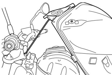
9. Heben Sie das vordere Ende des Kraftstofftanks an und stützen Sie ihn ab, wie in der Abbildung oben gezeigt. Setzen Sie das kreisförmige Ende der Stütze an der Lenkschaftmutter an.
