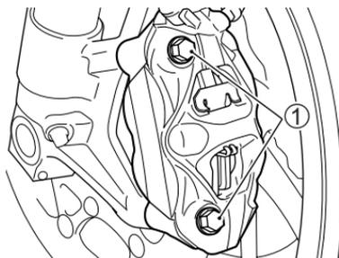
3. Nehmen Sie beide Bremssättel von den Teleskopgabelholmen ab, indem Sie die 2 Befestigungsschrauben ① an jedem Bremssattel herausdrehen.
