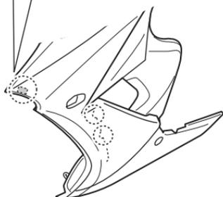
8. Entsichern Sie den Haken, der am Kühler befestigt ist, von der Unterseite der Verkleidung, und ziehen Sie die Verkleidung vorsichtig heraus.
