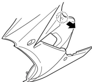
7. Nehmen Sie die Verkleidungen, rechts und links, eine nach der anderen ab. Entsichern Sie den Haken an der Innenseite der Verkleidung.
