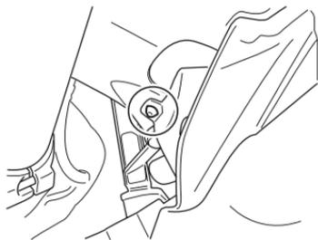
**ANMERKUNG:** Achten Sie darauf, die Innenseite der Verkleidung nicht mit dem Kühler oder dem Rahmen in Berührung zu bringen. Andernfalls kann der Dämpfer an der Innenseite abgetrennt werden.
