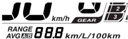
Wenn die Zündung eingeschaltet wird, werden alle LCD-Segmente angezeigt. Wird hierbei nur km (km/h) auf dem LCD angezeigt, ist Umschaltung auf Meilen (mph) nicht möglich, da es sich beim Instrument um eine Kilometer-Ausführung handelt.
