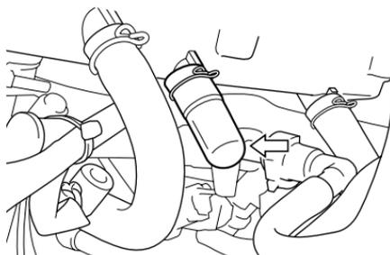
Bei Ablauf des regelmäßigen Wartungsintervalls drehen Sie die Schraube heraus, und lassen Sie Wasser sowie Öl ablaufen. Die Luftfilter-Ablassschraube befindet sich unter dem Luftfiltergehäuse.
