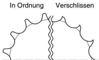
*ZUR BEACHTUNG: Vor Einbau einer neuen Antriebskette sollten die beiden Kettenräder auf Verschleiß geprüft und bei Bedarf ebenfalls ausgetauscht werden.*
