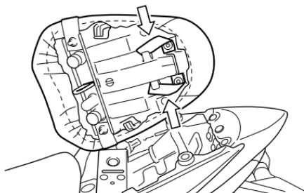
Die Gepäckschlaufen befinden sich gefaltet unter dem Sitz. Ziehen Sie die Schlaufen von den Haken, führen Sie sie nach außen und bringen Sie den Sitz wieder an. Gepäck auf dem Sitz kann mit Spanngurten oder Ähnlichem an den Schlaufen gesichert werden.
