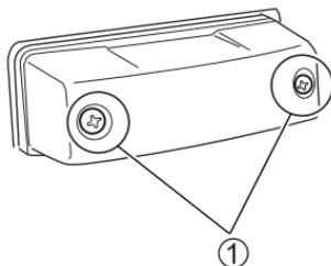
1. Drehen Sie die Schrauben ① heraus, und nehmen Sie die Abdeckung mit der Streuscheibe ab.
