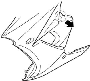
7. Nehmen Sie die Verkleidungen, rechts und links, eine nach der anderen ab. Haken Sie den Haken an der Innenseite der Verkleidung aus.
