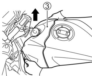
6. Entfernen Sie die Schrauben und Befestigungselemente auf beiden Seiten. Ziehen Sie die obere Kraftstofftankabdeckung ③ nach oben.
