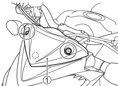
1. Drehen Sie die Schrauben heraus. Haken Sie den Haken aus und entfernen Sie die Abdeckung ① der Instrumenteneinheit.
