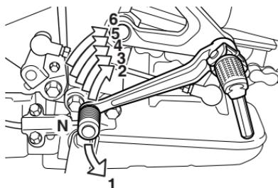
Dieses Motorrad ist mit einem 6-Gang-Getriebe ausgestattet, das wie dargestellt geschaltet wird. Zum Schalten ziehen Sie die Kupplung und nehmen das Gas weg, während Sie gleichzeitig den Schalthebel betätigen. Zum Hochschalten ziehen Sie den Schalthebel nach oben, zum Herunterschalten drücken Sie ihn nach unten. Der Leerlauf liegt zwischen dem 1. und 2. Gang. Um in den Leerlauf zu schalten, drücken oder ziehen Sie den Hebel zwischen den 1. und 2. Gang.
