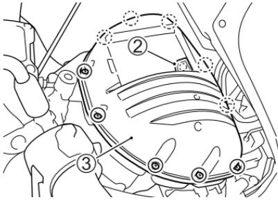
3. Entfernen Sie den Luftfilterdeckelstopfen ②. Drehen Sie die 11 Schrauben heraus. Entfernen Sie den Luftfilterdeckel ③.
