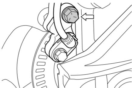
2. Nehmen Sie die Halterung des Hinterraddrehzahlsensors an der Befestigungsschraube ab.
