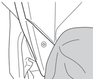
3. Legen Sie ein Tuch zwischen Instrumententafel und Kraftstofftank, um eine Beschädigung des Kraftstofftanks zu vermeiden.
