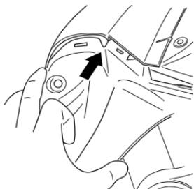
3. Drücken Sie das vordere Ende der Instrumententafel in Pfeilrichtung.
