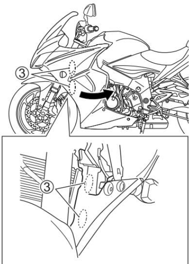
3. Drücken Sie die Verkleidung leicht zur Innenseite des Motorrads, und schieben Sie sie nach hinten in den Haken am Kühler ③ hinein.
