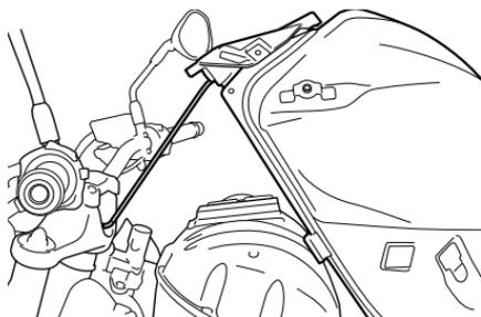
9. Heben Sie das vordere Ende des Kraftstofftanks an und stützen Sie ihn ab, wie in der Abbildung oben gezeigt. Setzen Sie das runde Ende der Stütze in die Lenkkopfmutter ein.
