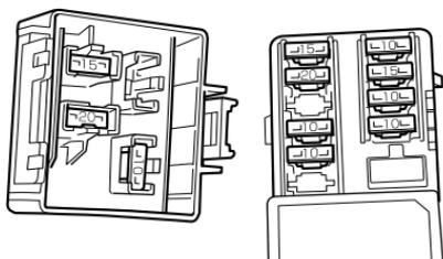
Die Sicherungen befinden sich unter dem Vordersitz. Im Sicherungskasten befinden sich drei Reservesicherungen (je eine Sicherung mit 20 A, 15 A und 10 A).
