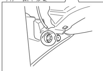
2. Nehmen Sie rechts und links die Schrauben und inneren Befestigungselemente der Verkleidung ab.
