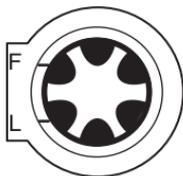
4. Halten Sie das Motorrad senkrecht und prüfen Sie den Motorölstand im Schauglas an der rechten Seite des Motors. Der Motorölstand soll zwischen den Linien „L“ (niedrig) und „F“ (voll) liegen.
