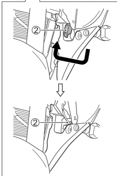
2. Bewegen Sie die Verkleidung nach vorn, wobei Sie den oberen Teil ① der Verkleidung als Drehachse nutzen, und passen Sie die Scheinwerfer-Befestigungssitzfläche ② in die Kerbe an der Innenseite der Verkleidung ein.
