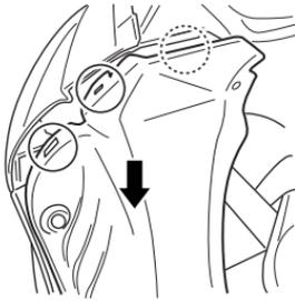
5. Ziehen Sie die Instrumententafel zum hinteren Ende des Motorrads heraus (in Pfeilrichtung). Dabei lösen sich auch die Haken (mit gepunktetem Kreis gekennzeichnet).
