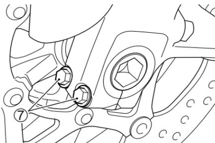
16. Ziehen Sie die Achshalterschrauben ⑦ mit dem vorgeschriebenen Anzugsdrehmoment fest.
