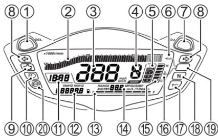
Die Störungsanzeigeleuchte ⑨, die Traktionskontrollsystem-Anzeigeleuchte ⑰, die Anzeigeleuchte für Kühlmitteltemperatur/Öldruck ⑲, die Anzeigeleuchte für das ABS ⑳, und die LCDs durchlaufen folgende Funktionsprüfung, wenn der Zündschalter auf die Stellung „ON“ gedreht wird.
