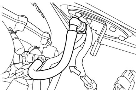
Prüfen Sie den Kraftstoffschlauch auf Beschädigung und Undichtigkeit. Falls Defekte gefunden werden, muss der Kraftstoffschlauch ausgewechselt werden.
