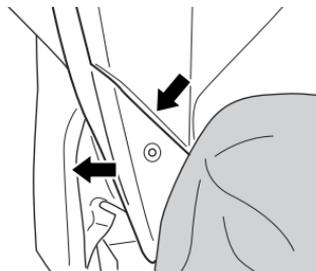
5. Drücken Sie die Verkleidung leicht zur Außenseite des Motorrads (Pfeilrichtung), und setzen Sie die Passfläche am Hinterende der Instrumententafel unter der Verkleidung ein. Prüfen Sie, dass die Haken auf der Außenseite der Instrumententafel fest sitzen.
