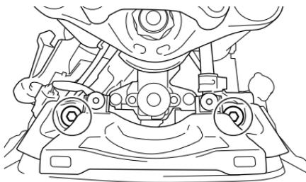
8. Drehen Sie die Kraftstofftank-Passschrauben heraus.
