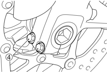
6. Lösen Sie die Achshalterschrauben ④.
