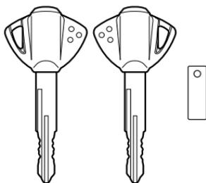
Dieses Motorrad wird mit einem Paar identischer Zündschlüssel ausgeliefert. Bewahren Sie den Reserveschlüssel an einem sicheren Ort auf. Wenn alle Schlüssel verloren gehen, muss das ECM ausgetauscht werden. (Modell mit Wegfahrsperre)
