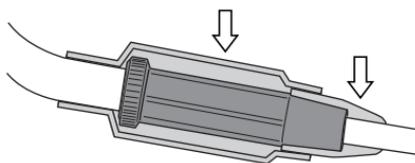
Der Gaszug ist mit Manschetten versehen. Stellen Sie sicher, dass die Manschetten richtig sitzen. Lassen Sie beim Waschen das Wasser nicht direkt auf die Manschetten gelangen. Wischen Sie Schmutz gegebenenfalls mit einem nassen Tuch von den Manschetten ab.
