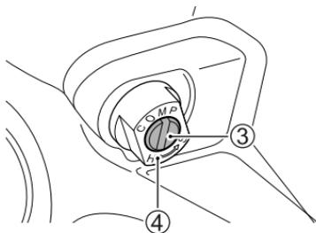
Um den Einfederdämpfungskraft-Einsteller in die Standardposition zu bringen, drehen Sie ihn bis zum Anschlag im Uhrzeigersinn und drehen Sie ihn dann um 2 Umdrehungen entgegen dem Uhrzeigersinn.
