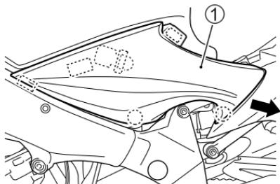
3. Die rechte und linke Rahmenabdeckung besitzt an den mit einem Rechteck markierten Stellen Befestigungselemente hinter der Abdeckung. Zum Lösen der Befestigungselemente ziehen Sie die seitlichen Rahmenabdeckungen ① nach oben. Die seitlichen Rahmenabdeckungen besitzen Haken hinter den mit einem Kreis gekennzeichneten Stellen. Zum Abnehmen vom Haken schieben Sie die seitliche Rahmenabdeckung ① nach hinten.
