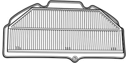
Kontrollieren Sie den Zustand des Luftfiltereinsatzes. Ersetzen Sie den Luftfiltereinsatz regelmäßig.
