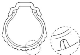
Kontrollieren Sie den Zustand der Reifen vor jeder Fahrt. Wenn ein Reifen sichtbare Anzeichen einer Beschädigung aufweist, wie z. B. Risse oder Einschnitte, bzw. wenn die Profiltiefe beim Vorderreifen 1,6 mm (0,06 in) und beim Hinterreifen 2,0 mm (0,08 in) unterschreitet, ist der Reifen auszuwechseln.
