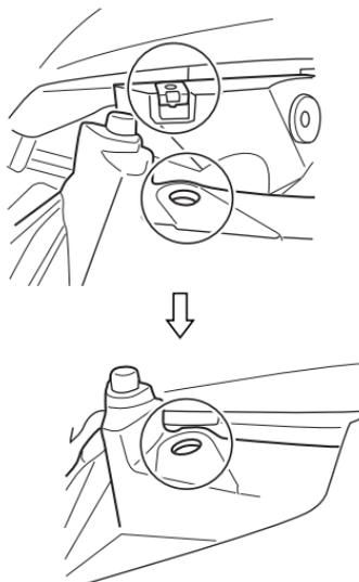
*ZUR BEACHTUNG: Wenn das Einsetzen des Kühlerhakens ③ abgeschlossen ist, kann die Innenseite der Verkleidung (Ausbauverfahren 6. Schraubenanziehabschnitt) ausgerichtet werden.*
