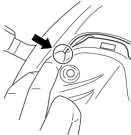
2. Während sich die Außenseite des vorderen Endes der Instrumententafel leicht wölbt, setzen Sie sie vorsichtig an der mit dem Kreis gekennzeichneten Stelle ein, und achten Sie darauf, dass sie mit den Haken ausgerichtet ist.
