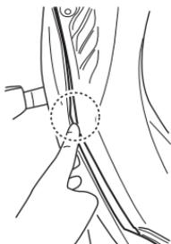
4. Befestigen Sie die Haken (mit gepunktetem Kreis gekennzeichnet) an der Seite der Instrumententafel.
