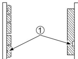
Prüfen Sie, ob die Vorder- und Hinteradbremsbeläge bis zur Verschleißlinie ① abgenutzt sind. Ist ein Bremsbelag bis zur Verschleißlinie abgenutzt, müssen beide Bremsbeläge des entsprechenden Rades von Ihrem autorisierten Suzuki-Händler oder von qualifizierten Fachpersonal durch Neuteile ersetzt werden.
