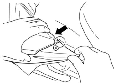
**ZUR BEACHTUNG:** Beim Anziehen der Schraube ③ am Hinterende der Instrumententafel kann die Passung um die Tafel verbessert werden, indem die Arbeit durchgeführt wird, während die Unterseite der Instrumententafel und die Stirnfläche der Verkleidung (mit Kreis markierte Stelle) in Pfeilrichtung gedrückt werden, sodass sie ausgerichtet sind.
