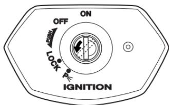
Die Schlüsselöffnung kann durch Drehen der Abdeckung abgedeckt werden.
