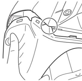
1. Zum Anbringen der Instrumententafel beginnen Sie am vorderen Teil. Setzen Sie das vordere Ende der Instrumententafel wie in der Abbildung dargestellt in der Mitte am Ende der Verkleidung (mit Kreis gekennzeichnet) leicht ein.
