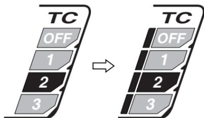
1. Drücken Sie den Schalter für das Traktionskontrollsystem ⑥, um den gewünschten Modus zu wählen.
