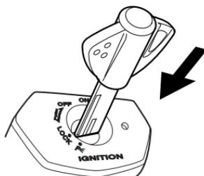
Beim Einstecken des Schlüssels drehen Sie die Abdeckung so, dass die Öffnung über der für den Schlüssel liegt.
