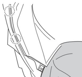
4. Zum Abnehmen der Instrumententafel beginnen Sie am hinteren Teil. Drücken Sie die Verkleidung leicht zur Außenseite des Motorrads (Pfeilrichtung), und heben Sie die Passfläche am Hinterende der Instrumententafel über die Verkleidung. Entriegeln Sie den Haken (mit gepunktetem Kreis gekennzeichnet) an der Seite der Instrumententafel.
