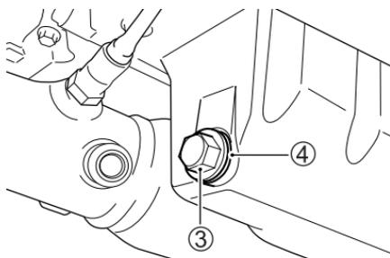
4. Nehmen Sie die Ablassschraube ③ sowie die Dichtung ④ von der Unterseite des Motors ab, und lassen Sie das Motoröl in eine geeignete Wanne ablaufen.
