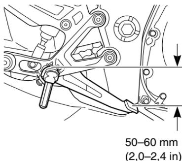
Das Bremspedal muss 50–60 mm (2,0–2,4 in) tiefer liegen als die Oberseite der Fußraste.
