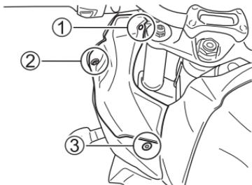
6. Ziehen Sie dann in der nummerierten Reihenfolge das Befestigungselement ① und die Schraube ② am vorderen Ende der Instrumententafel, sowie die Schraube ③ am Hinterende der Instrumententafel an.
