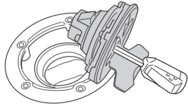
Zum Öffnen des Tankdeckels stecken Sie den Zündschlüssel in das Schloss und drehen Sie ihn im Uhrzeigersinn. Öffnen Sie den Tankdeckel mit dem Schlüssel. Zum Schließen drücken Sie den Tankdeckel mit dem im Deckelschloss steckenden Schlüssel fest nach unten.
