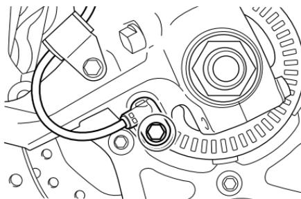
2. Nehmen Sie den Vorderraddrehzahlsensor nach Herausdrehen der Befestigungsschraube ab.
