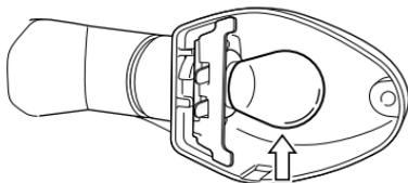
2. Drücken Sie die Glühlampe hinein, drehen Sie sie nach links, und ziehen Sie sie heraus.
