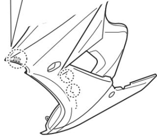
8. Haken Sie von der Unterseite der Verkleidung aus den am Kühler befestigten Haken aus, und ziehen Sie die Verkleidung vorsichtig heraus.
