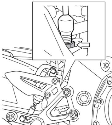
Um den Bremslichtschalter einzustellen, halten Sie das Schaltergehäuse und drehen Sie den Einsteller so, dass das Bremslicht bei Betätigung des Bremspedals kurz vor dem Druckpunkt aufleuchtet.
