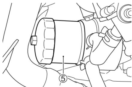
5. Drehen Sie den Ölfilter ⑤ entgegen dem Uhrzeigersinn und nehmen Sie ihn ab. Verwenden Sie hierzu einen Suzuki-Aufsetz-Ölfilterschlüssel oder einen Band-Filterschlüssel geeigneter Größe.
