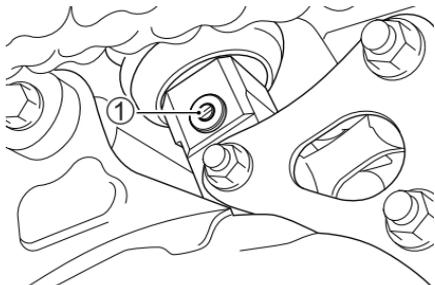
Um den Ausfederdämpfungskraft-Einsteller in die Standardposition zu bringen, drehen Sie ihn bis zum Anschlag im Uhrzeigersinn und drehen Sie ihn dann um 1 Umdrehung entgegen dem Uhrzeigersinn.
