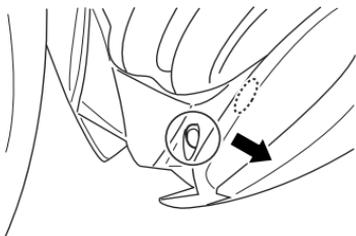
3. Entfernen Sie das untere Befestigungselement der Verkleidung. Haken Sie die Haken am unteren Teil der Verkleidung der linken Seite aus.
