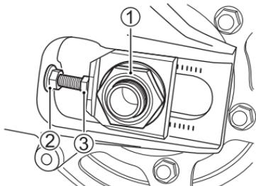
3. Schrauben Sie die Achsmutter ① ab.
