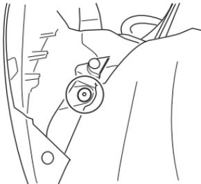
6. Nehmen Sie die Schrauben und Befestigungsteile an der Innenseite der rechten und linken Verkleidung ab.
