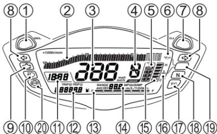
Zum Ändern der Anzeige drücken Sie die Taste SEL ① oder den Schalter MODE (Aufwärts) auf der linken Lenkerseite. Die Anzeige ändert sich in der nachstehenden Reihenfolge.
