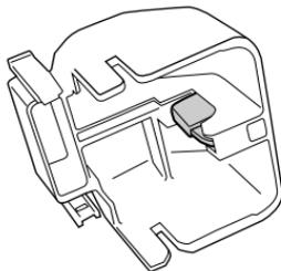
Die Hauptsicherung befindet sich unter dem Vordersitz. Um Zugang zur Sicherung zu erhalten, nehmen Sie den Vordersitz gemäß Beschreibung im Abschnitt SITZSCHLOSS UND HELMHALTER ab. Im Sicherungskastendeckel befindet sich eine 30 A Reservesicherung.
