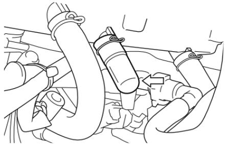
Bei der turnusgemäßen Wartung drehen Sie die Schraube heraus und lassen Wasser sowie Öl ab. Die Luftfiltereinsatz-Ablassschraube befindet sich unter dem Luftfiltergehäuse.
