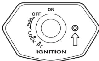
Beim Einschalten der Zündung blinkt die Wegfahrsperr-Anzeigelampe zweimal. Anschließend leuchtet die Anzeige 2 Sekunden lang und geht dann aus.
