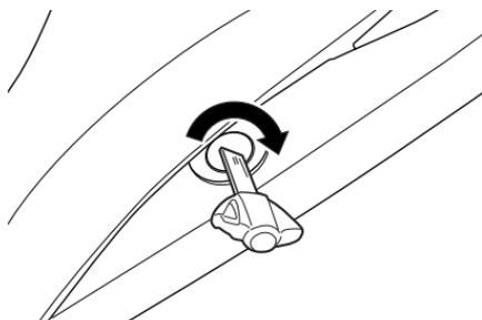
Das Sitzschloss befindet sich unter der linken Rahmenabdeckung. Zum Ausbauen des Rücksitzes setzen Sie den Zündschlüssel in das Schloss ein und drehen ihn im Uhrzeigersinn. Heben Sie den Sitz vorn an und ziehen Sie ihn nach vorn.
