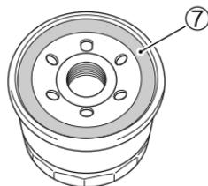
7. Verteilen Sie ein wenig Motoröl um die Gummidichtung ⑦ des neuen Ölfilters.
