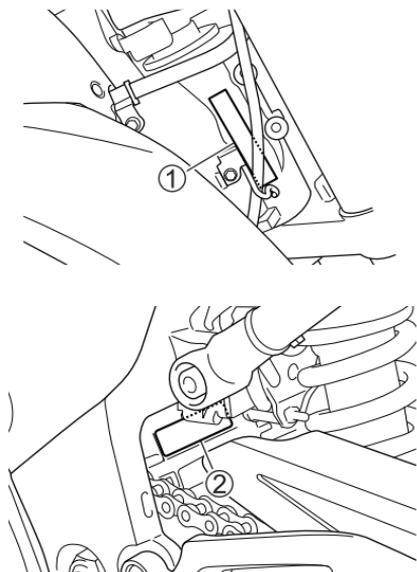
Die Seriennummer des Rahmens und/oder des Motors werden für die Anmeldung des Motorrads benötigt. Außerdem erleichtern sie Ihrem Händler die Bestellung von Teilen und das Auffinden spezieller Wartungsinformationen. Die Rahmennummer ① ist am Lenkkopfrohr eingestanzt. Die Motornummer ② ist am Kurbelgehäuse eingestanzt.
