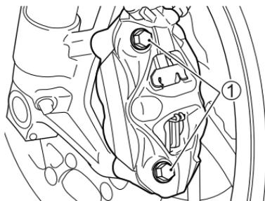
3. Nehmen Sie beide Bremssättel von den Teleskopgabeln ab, indem Sie die 2 Befestigungsschrauben ① an jedem Bremssattel herausdrehen.
