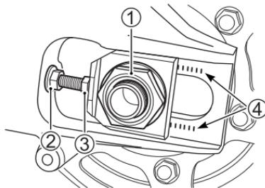
2. Lösen Sie die Achsmutter ①.
