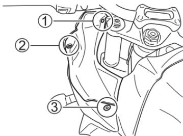
2. Nehmen Sie das Befestigungselement ①, die Schraube ② und die Schraube ③ der rechten und linken Instrumententafel ab.
