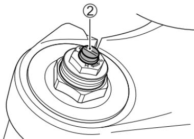
Um den Ausfederdämpfungskraft-Einsteller in die Standardposition zu bringen, drehen Sie ihn bis zum Anschlag im Uhrzeigersinn und drehen Sie ihn dann um 8 Raststellen im Gegenuhrzeigersinn.
