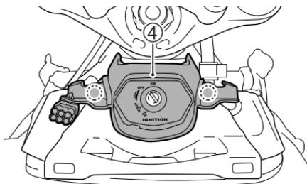
7. Haken Sie die Haken aus und entfernen Sie die untere Kraftstoffabdeckung ④.
