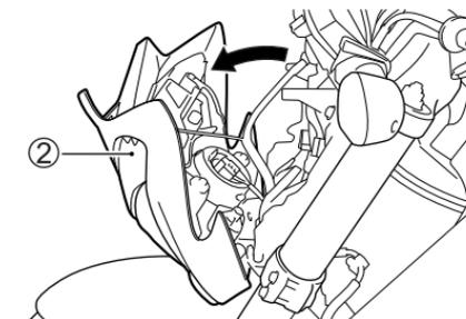
2. Drehen Sie die Schrauben heraus. Ziehen Sie die Scheinwerferbaugruppe ② nach vorn.
