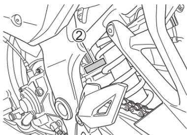
Die Seriennummer des Rahmens und/oder des Motors werden für die Anmeldung des Motorrads benötigt. Außerdem erleichtern sie Ihrem Händler die Bestellung von Teilen und das Auffinden spezieller Wartungsinformationen. Die Rahmennummer ① ist am Lenkkopfrohr eingestanzt. Die Motornummer ② ist am Kurbelgehäuse eingestanzt.
