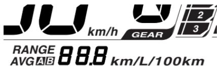
Wenn die Zündung eingeschaltet wird, werden alle LCD-Segmente angezeigt. Wird hierbei nur km (km/h) auf dem LCD angezeigt, ist das Umschalten auf Meilen (mph) nicht möglich, da es sich beim Instrument um eine Kilometer-Ausführung handelt.
