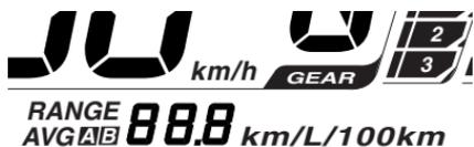
Wenn die Zündung eingeschaltet wird, werden alle LCD-Segmente angezeigt. Wird hierbei nur km (km/h) auf dem LCD angezeigt, ist das Umschalten auf Meilen (mph) nicht möglich, da es sich beim Instrument um eine Kilometer-Ausführung handelt.
