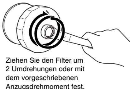
11. Markieren Sie die 12-Uhr-Position am Aufsetz-Ölfilterschlüssel oder am Ölfilter. Ziehen Sie den Filter mit einem Ölfilterschlüssel um 2 Drehungen bzw. mit dem vorgeschriebenen Anzugsdrehmoment fest.
