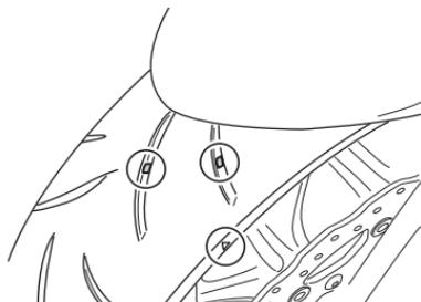
*ZUR BEACHTUNG: Die Markierung „ Δ “ zeigt die Stelle an, wo die Verschleißindikatoren im Reifen eingelassen sind. Wenn der Verschleißindikator dieselbe Höhe besitzt wie die Reifenoberfläche, ist die Verschleißgrenze des Reifens erreicht.*
