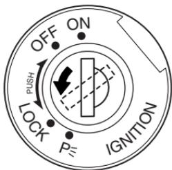
Die Schlüsselöffnung kann abgedeckt werden, indem man den Deckel dreht.
