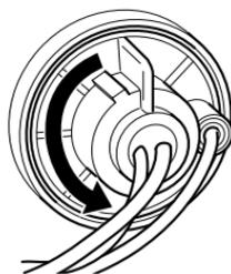
1. Drehen Sie die Fassung entgegen dem Uhrzeigersinn und nehmen Sie sie ab.
