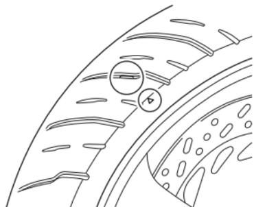
*ZUR BEACHTUNG: Die Dreieck-Markierung zeigt die Stelle an, wo die im Reifen eingelassenen Verschleißindikatoren sind. Wenn der Verschleißindikator dieselbe Höhe besitzt wie die Reifenoberfläche, ist die Verschleißgrenze des Reifens erreicht.*
