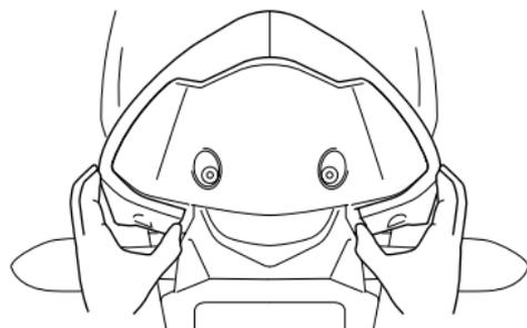
2. Erweitern Sie beim Entfernen der Streuscheibe die Rahmenabdeckungen, um Kratzer auf den Rahmenabdeckungen zu vermeiden.
