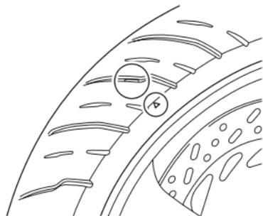
*ANMERKUNG: Die "Dreieck"-Markierung zeigt die Stelle an, wo die im Reifen eingelassenen Verschleißindikatoren sind. Wenn der Verschleißindikator die Straße berührt, ist die Verschleißgrenze des Reifens erreicht.*
