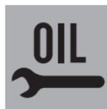
Wenn diese Anzeige aufleuchtet, ist es an der Zeit, das Motoröl zu wechseln. Die Anzeige leuchtet nach den ersten 1000 km auf. Das Voreinstellintervall kann in 500-km-Schritten zwischen 500 km und 4000 km festgelegt werden.
